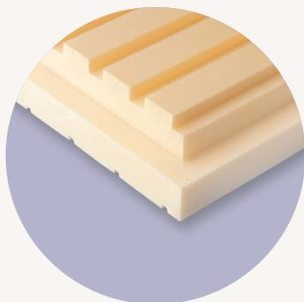
Panel de poliestireno extruido URSA XPS conforme a la norma UNE EN 13164, de superficie acanalada y canto a media madera. URSA XPS puede utilizarse dentro de un amplio margen de temperaturas que abarca desde -50°C hasta +75°C.
