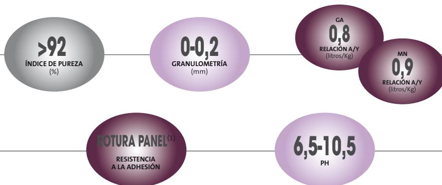
(1) Ensayo en laboratorio de adhesión sobre panel de yeso. Rotura mínima en 3/4 ensayos. Norma EN 12.860.
