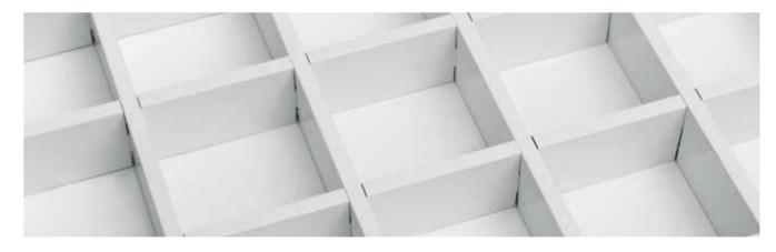
Rejillas fabricadas con aluminio prelacado de 0,40 mm de espesor más recubrimientos. Rejillas prelacadas en Poliéster con un espesor de capa de mínimo 20 micras en color Blanco y Silver (RAL 9006). Este tipo de acabado se caracteriza por una alta resistencia a la corrosión y durabilidad.
