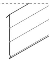
Lamas fabricadas con aluminio prelacado de 0,45 mm de espesor más recubrimientos conformadas por laminación en frío. Lamas prelacadas en Poliéster con un espesor de capa de 20 micras en ambas caras en color Blanco Mate (Ref. 9723) o Silver (RAL 9006). Este tipo de acabado se caracteriza por una alta resistencia a la corrosión y durabilidad (retención de brillo y color).
