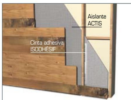
Respetar una cámara de aire de 20 mm como mínimo en cada una de las caras del aislante.
